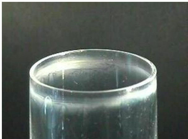
Bild 1: Lokale Trübung am Mundrand (Quelle: Kurzreferate 77. Glastechnische Tagung Leipzig 2003, S. 55-58)
