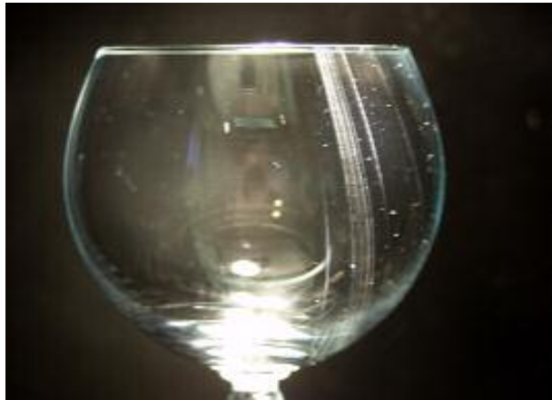
Bild 3: Linienkorrosion (Quelle: Kurzreferate 77. Glastechnische Tagung Leipzig 2003, S. 55-58)
